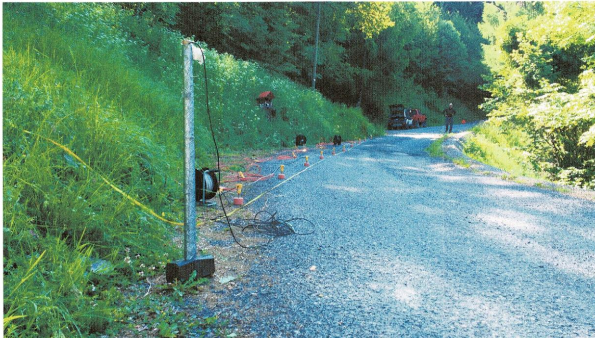
Foto 1 – Esecuzione prospezione sismica a rifrazione S1 e acquisizione Masw
